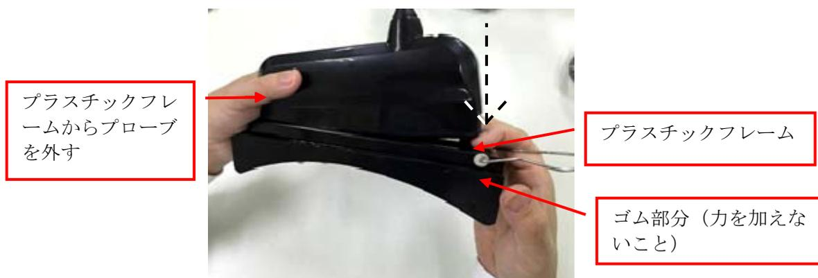
図 E-2 プラスチックフレームを外す
