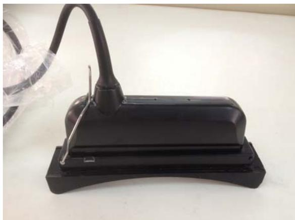
図 E-5 スペーサーの組み立てと固定
